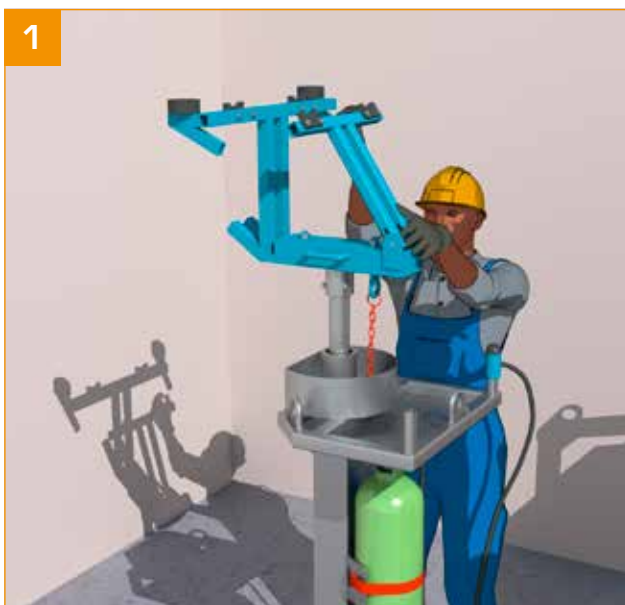
- Déplier le bras arrière du MaxUp et le verrouiller.
